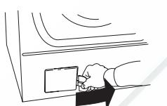
2. Используя съемную разделятельную стенку для жидкых моющих средств, откройте дверцу сливного насоса как показано на рисунке.
