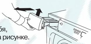
Сполосните и помойте щеткой отделения емкости для моющего средства и прополоскывателя для того, чтобы удалить все остатки моющих средств с внутренней поверхности и стенок емкости. Установите емкость на место.
