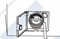
4. Откройте насос поворачивая его крышку против часовой стрелки. Выньте крышку и фильтр-ловушку.
